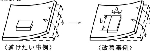
ストレスの作用する方向に対して、横向き(長さ:a<b)に部品を配置して下さい。
